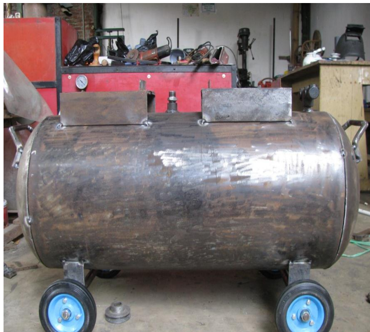
Gambar 3. Manufaktur tabung gas metana
